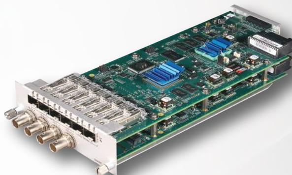
SMART Media Delivery Platform™ è un gateway multifunzione con 4 ingressi 3G / HD / SD-SDI-over-IP con riconoscimento automatico del segnale, include un switch Layer 2/3. La piattaforma SMART è stata progettata per collegarsi senza problemi alla rete IP, senza la necessità di elementi di rete esterni. Le funzionalità della piattaforma possono essere aggiunte o aggiornate tramite download del software.
