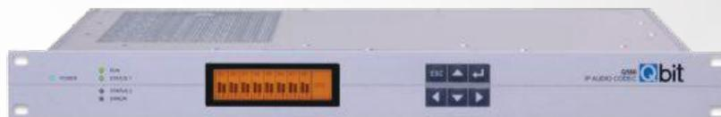
Il **Q560** è un codec audio per un massimo di 4 canali bidirezionali stereo (AES / EBU digitale) o 2 canali stereo bidirezionali (analogico e digitale AES / EBU). Compatto (alloggiamento 19 "1U), ad alta efficienza energetica (<2 W per canale stereo in versione AES / EBU), hardware basato su DSP. Le interfacce disponibili sono IP, ISDN, E1 e X.21.
