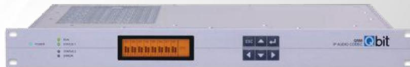
**Q565-FM** può ricevere fino a 8 canali radio FM e convertirli in un flusso di trasporto MPEG-2 compatibile con DVB..L'output può essere IP o DVB-ASI. Il dispositivo può essere utilizzato per rendere disponibili programmi radio FM ricevuti localmente all'infrastruttura digitale degli operatori di reti via cavo. Grazie al suo hardware basato su DSP, il Q565-FM è compatto (alloggiamento da 19 "1U) e ad alta efficienza energetica (<2 W per canale stereo).
