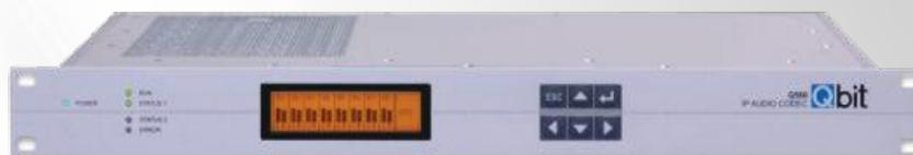
Il **Q562** è un decodificatore audio per un massimo di 8 canali stereo (AES / EBU digitale) o fino a 4 canali stereo (AES / EBU analogici e digitali). Compatto (alloggiamento 19 "1U), ad alta efficienza energetica (<2 W per canale stereo in versione AES / EBU), hardware basato su DSP. Decodifica di flussi elementari o flussi di trasporto MPEG-2 conformi a DVB in ingresso su IP o ASI.
